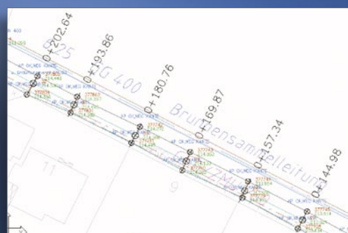
Konstruktion der Leitung mit Interpolation der Geländepunkte.
