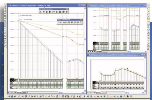
Oberfläche mit WV-Ortsnetz und Längsschnitt mit Druckhöhen.
