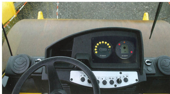
Bild 1: Der Economizer von Bomag misst den Verdichtungsgrad und zeigt ihn leicht verständlich an
