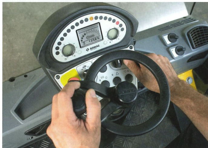
Bild 2: Auch auf den Bomag Walzenzügen ist der Economizer nun als Verdichtungsmessinstrument verfügbar
