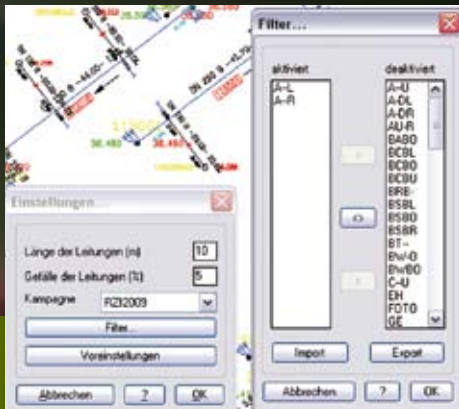
Neu im Bereich Kanalschaden ist das automatisierte Erzeugen von Hausanschlüssen via Angabe des Kürzels.
