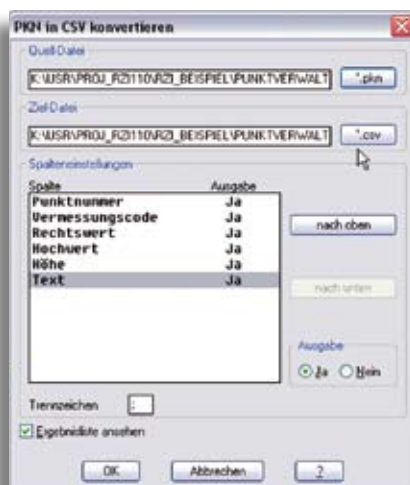
Der neue CSV-Konverter wandelt RZI-Punkte ins CSV-Format und umgekehrt. Über den Auswahldialog steuern Sie die Reihenfolge der Spalten und die Ausgabe.
