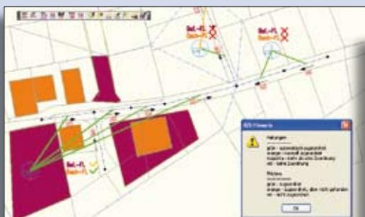
Interaktive Flächenermittlung in der Konstruktion eines Einzugsgebietes: Ein Mausklick auf die Fläche im Layer der Zeichnung genügt.
