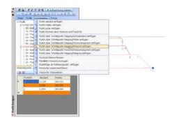
So haben Sie die Möglichkeit, Punkte polar oder absolut, über Neigungen oder Schnittpunkte oder über Dehnen und Stutzen einzufügen.
