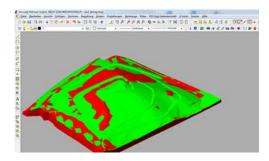
Jedes DGM lässt sich gesondert parametrieren. Die Triangulierung läuft schnell und liefert Hinweise auf den Status des DGM. Verwalten lassen sich beliebig viele DGM. Die Berechnung erfolgt REB-konform.
